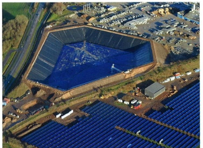
Großes Vorbild. Eine Solar-Großanlage in Verbindung mit einem Erdbeckenspeicher steht seit 2015 in der dänischen Kleinstadt Vojens, deren Heizbedarf damit zu fast 50 Prozent gedeckt wird.
